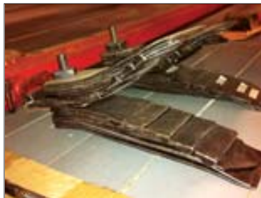
40. Коленчатые (v-образные) рессоры, демонтированные с кареты кн. Ирины Михайловны Юсуповой. В процессе реставрации.
