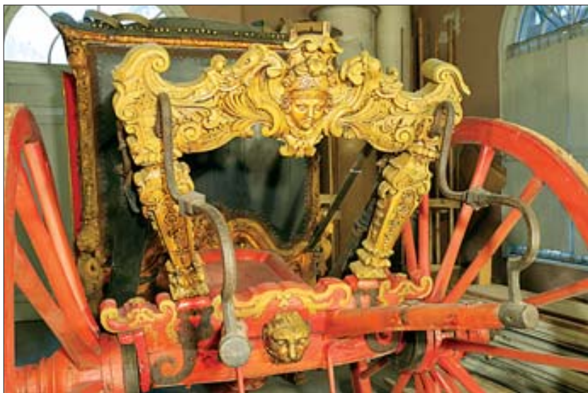
35. Карета княгини И.М. Юсуповой. Деталь: конструктивные столбы с поперечной перекладной на запятках, украшены барочной резьбой с маскаронами. До реставрации.
